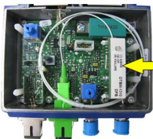
3. Insertar el transmisor óptico TO LR **xx xx** y realizar la conexión al conector de salida
