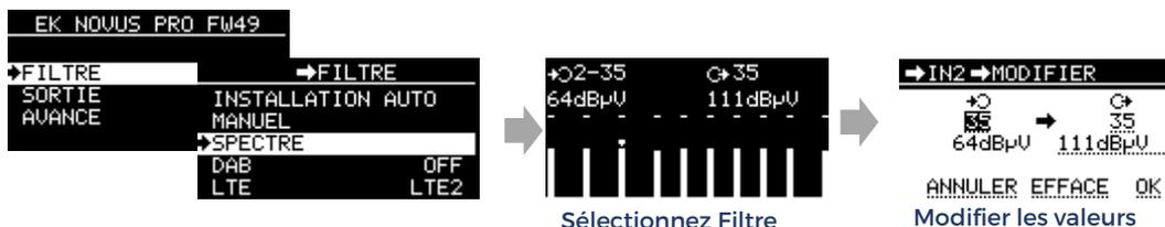
L'option SPECTRUM vous permet d'effectuer les mêmes actions sur les filtres que l'option MANUEL, avec l'avantage supplémentaire que, d'un coup d'œil, vous pouvez voir tous les filtres programmés et qu'il n'est pas nécessaire de sélectionner l'entrée. Il s'agit simplement d'une alternative puissante, offrant à l'installateur la possibilité de choisir l'option qu'il préfère pour gérer les filtres en fonction de ses besoins.
