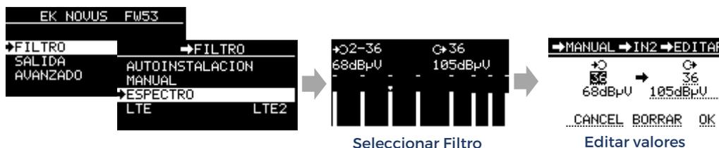
La opción ESPECTRO permite realizar las mismas acciones sobre los filtros que la opción MANUAL, con la ventaja adicional de que, de un vistazo, se pueden ver todos los filtros programados y no es necesario seleccionar la entrada. Es simplemente una potente alternativa, ofreciendo al instalador la libertad de elegir la opción que prefiera para gestionar los filtros según sus preferencias.
