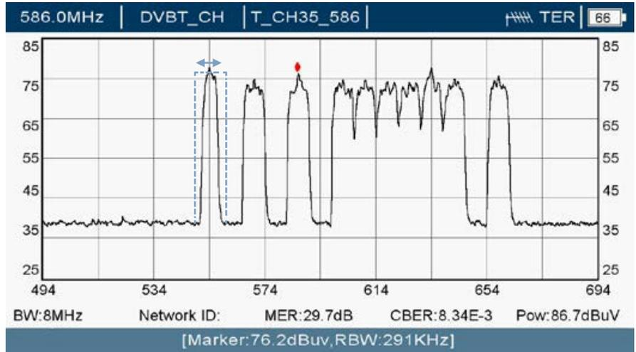
**Ajuste del nivel de salida (filtro seleccionado):** Utilizando las teclas superior e inferior del joystick, se puede ajustar el nivel de salida del filtro seleccionado. Para confirmar los cambios, debe pulsar el botón central del joystick.
