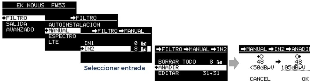
**Editar un filtro existente:** Con las teclas superior e inferior del joystick, seleccione el filtro que desea editar. Esta opción permite modificar la frecuencia, el nivel o eliminar el filtro seleccionado.
