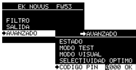
**Nota:** En caso de olvido del PIN para acceder a los controles de la central, será necesario forzar un RESET. Para ello, desconecte la central de la red eléctrica luego vuelva a conectarla mientras mantiene pulsada la tecla central unos segundos. Tenga en cuenta que este procedimiento eliminará todas las configuraciones previamente guardadas.
