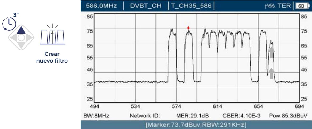
**SALIR:** Para interrumpir el parpadeo de un filtro seleccionado sin guardar los cambios y salir del MODO VISUAL, debe pulsarse la tecla izquierda del joystick durante 3 segundos. Alternativamente, si no se realiza ninguna acción con el joystick durante un minuto, el equipo saldrá automáticamente del MODO VISUAL sin guardar los cambios.
