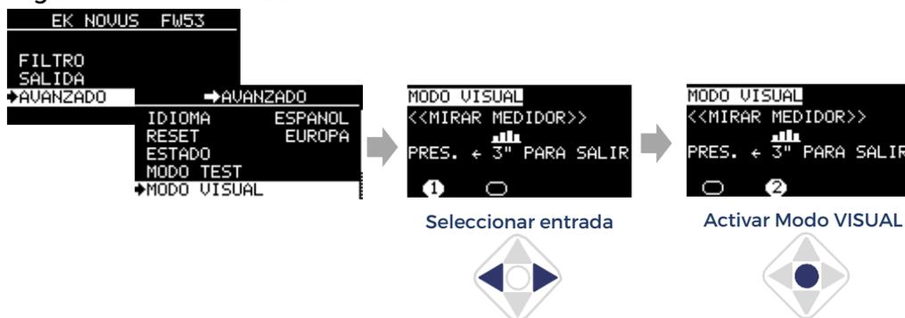
Al activar el modo VISUAL con un clic central, el canal seleccionado comienza a parpadear en el medidor de campo, lo que facilita su identificación visual. Utilizando las teclas de dirección del joystick, se puede cambiar la frecuencia, ajustar el nivel de salida o eliminar el filtro. Con una nueva pulsación central, se selecciona el canal inmediatamente superior en frecuencia.
