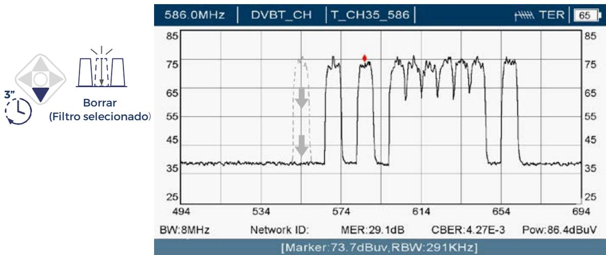
**Creación de un filtro nuevo:** Al mantener pulsada la tecla superior del joystick durante 3 segundos, aparecerá un nuevo filtro parpadeando. Con las teclas laterales se puede ajustar la frecuencia de entrada y salida. Para confirmar la creación del filtro, debe pulsarse el botón central del joystick.
