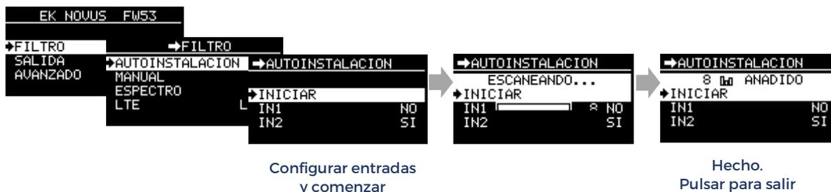
Por defecto, se escanean todas las entradas. Para un escaneo más rápido, es recomendable deshabilitar previamente las entradas no conectadas.
