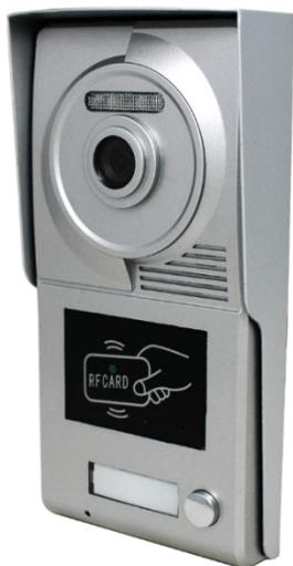
Placa de calle con cámara de alta calidad de imagen y sistema de autodetección de falta de luminosidad. Dispone de un pulsador de vivienda y sistema de control de acceso mediante RFID Mifare. La placa PE 1BM se integra en una visera de protección de aluminio, con sistema de anti pérdida de tornillo para instalarse en superficie.
