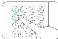
Si suena un pitido y el indicador LED se mantiene encendido durante 10 segundos, significa que la configuración se ha realizado correctamente.
