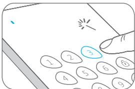
Si no se realiza ninguna operación en el modo de configuración durante un periodo de 10 segundos, el teclado saldrá automáticamente del modo de configuración. También puede pulsar [#] para salir.
