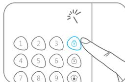
Si hay una intrusión, se disparará el sistema de alarma y sonará la sirena. El panel de control enviará un SMS y marcará automáticamente los números de teléfono almacenados previamente para notificar a los usuarios (la notificación por SMS sólo está disponible en sistemas de alarma GSM).
