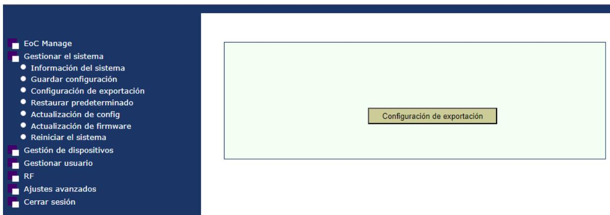
El fichero resultante se puede importar en cualquier equipo cargándolo como si fuese un nuevo FW en "Actualización de firmware". Tenga en cuenta que la configuración cargada en el master proviene de otro master con el mismo modelo y versión de FW.
