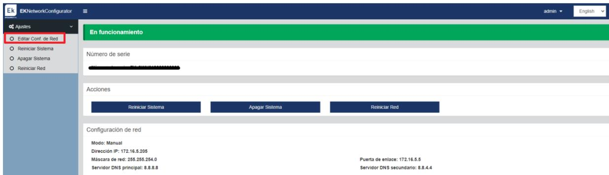
2. Configuramos una IP dentro de nuestra red, con su máscara y la puerta de enlace. Seguidamente guardamos la configuración. La configuración de la imagen es un simple ejemplo, por lo que no se ha de utilizar si no se comparte la misma configuración.
