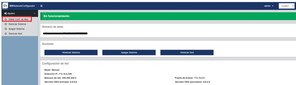
2. Configurez une IP sur votre réseau, avec son masque et la passerelle. Ensuite, sauvegardez la configuration. La configuration de l'image est un simple exemple ; il ne faut donc pas l'utiliser à moins de partager la même configuration.
