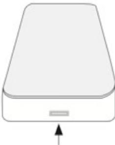
Inserte un destornillador pequeño de hoja plana en la ranura de abertura del transmisor y gírelo para extraer la tapa.
