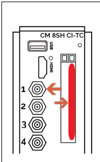
Entrada 1: ON – Sintonizador A – 22KHz. Desactivado.
