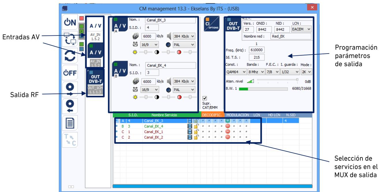
Figura 8. Detalle para identificación de las entradas A2 y B2 y parámetros modulador.
