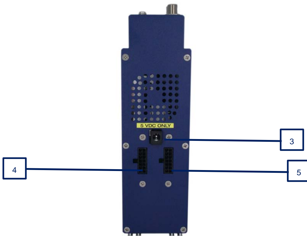
Figura 2. Conexiones de la base.
