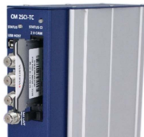
Figura 14. Inserción del módulo CAM
