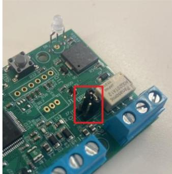
Para esta configuración únicamente se ha de conectar el Jumper en posición vertical tal como se indica en el esquema:
