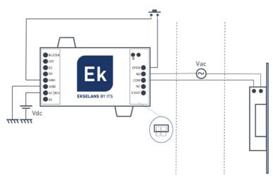
Configurazione a contatto a secco (la serratura si apre in base all'apertura o chiusura del circuito; il dispositivo di controllo funge da interruttore).
