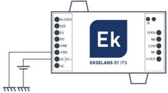
Se si alimenta il dispositivo di controllo con corrente alternata, collegare la fonte ai morsetti indicati con "AC e AC". Se si alimenta il dispositivo di controllo con corrente continua, collegare la fonte ai morsetti indicati con "GND e DC+". Rispettare la polarità.
