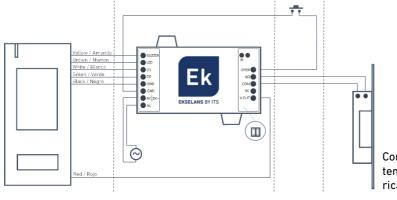
Configurazione a passaggio diretto (la stessa tensione che alimenta il dispositivo di controllo ricade anche sulla serratura).
