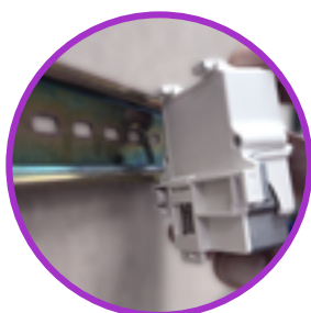
Ejemplo de fijación en carril DIN
