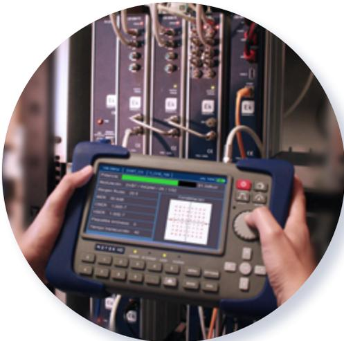
Entrada única RF para todas las bandas. Atenuador automático de alta precisión (hasta 45dB).
