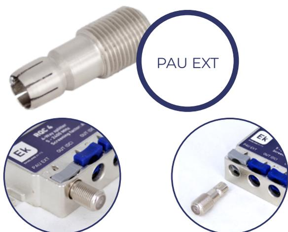
Para convertir los repartidores RQC 2 y 4 en dispositivos PAU conecte el adaptador PAU Extender en la entrada indicada. Esto permitirá disponer de una segunda entrada para conector F con carga de 75 Ohm en su interior
