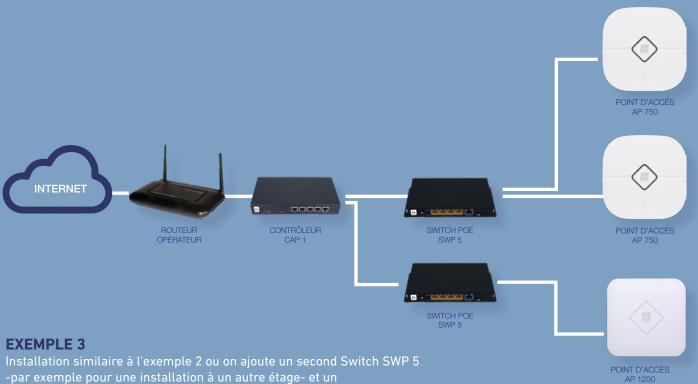
Installation similaire à l'exemple 2 ou on ajoute un second Switch SWP 5 -par exemple pour une installation à un autre étage- et un contrôleur CAP 1. Ceci permet de configurer les points d'accès depuis un point centralisé et de définir des paramètres complémentaires du réseau. Par exemple, assigner une bande passante spécifique à un utilisateur.
